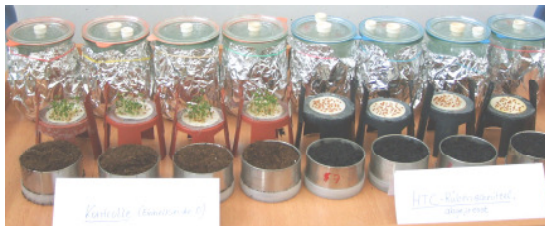
Abb. 3: Keimung der Kressesaat nach 7 Tagen; links: Kontrolle (1-4), rechts: abgepresste HTC-Rübenschnitzel-Biokohle
